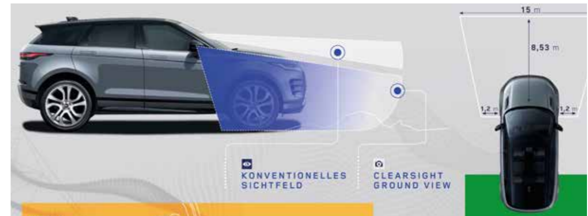
Kameras in den Außenspiegeln und am Kühlergrill sorgen dafür, dass der Fahrer auch alles knapp vor der Motorhaube im Blick hat.
